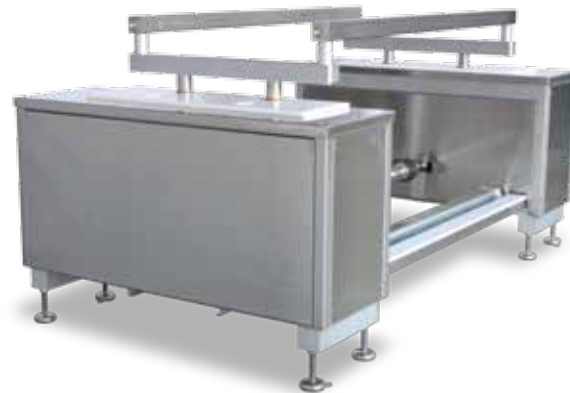
Basamento con servomotore a movimento orizzontale e verticale Vertical and horizontal moving base with servo-motors
